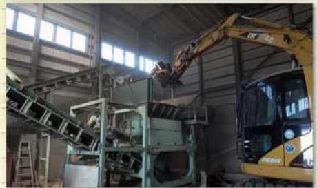
破碎後、磁選機を通して細かい鉄くずを取り除きます。なお、除去された鉄くずもきちんとリサイクルされています。
