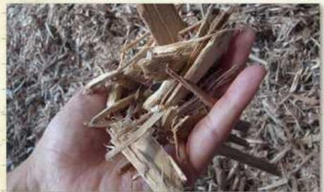
振動ふるい機にかけ、大きさをそろえていきます。4cmを超えるものはふたたびツインカッターにかけ、4cm以下になるまで、破碎→磁選機→ふるい工程を繰り返します。
